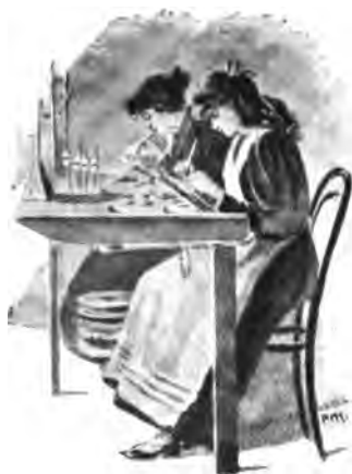
Inserindo os filamentos compostos dentro do globo
