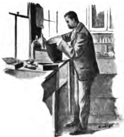
Tirando os filamentos do cadinho após carbonisação
