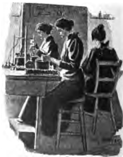
Soldando os filamentos em pontas de platina.
